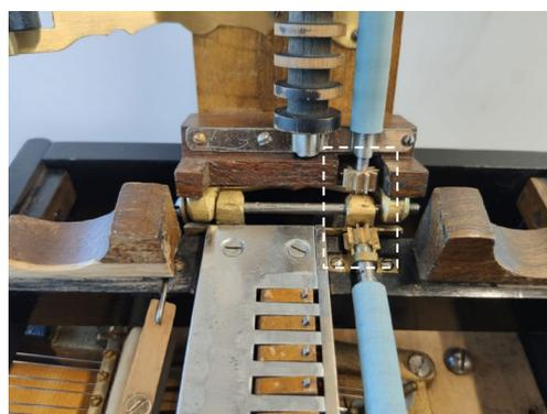
Figure 55 : Les pignons simples des cylindres de transport. État après traitement.
