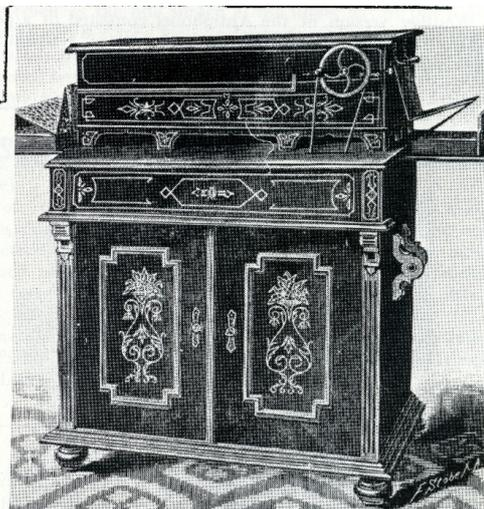
Figure 7 : Version « armoire » - vue fermée : « Piano Melodico Orchestrion » à 30 notes à entraînement à air chaud.
