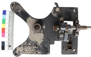
Figure 109 : Platine du mécanisme moteur empoussiérée et encrassée.
