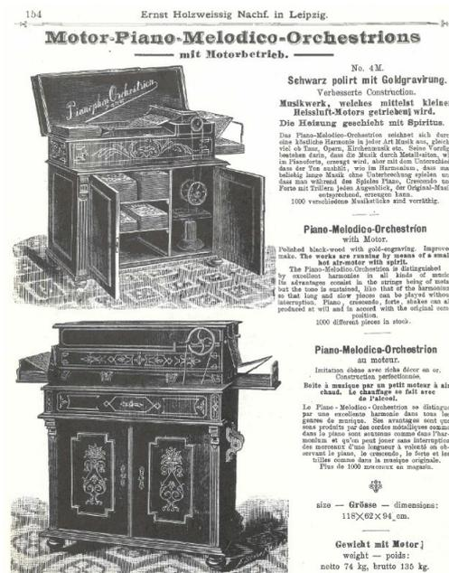
Figure 9 : « Piano-Melodico-Orchestrion » à moteur à air chaud, proposé dans le catalogue de Holzweissig en 1898.
